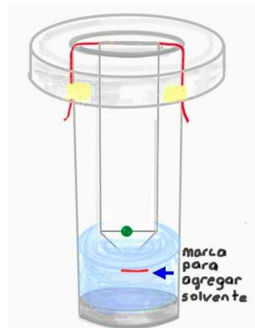
Figura 5.3 Montaje de la cromatografía (Diseño BPNG).
